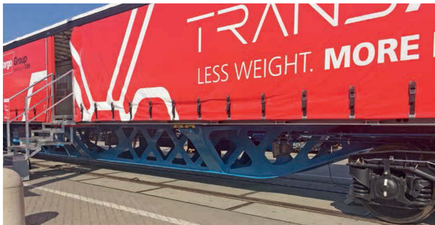
Der Fachwerkrahmen ist das Besondere am Transant-Güterwagen.
