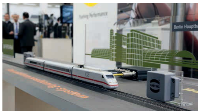
Genauere Bestimmung der Zugposition mittels RFID
