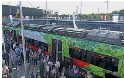
Der CityJet eco von Siemens für die ÖBB mit einem Batteriezusatzantrieb; auf dem Mittelwagen befinden sich u.a. die drei Batteriecontainer.
