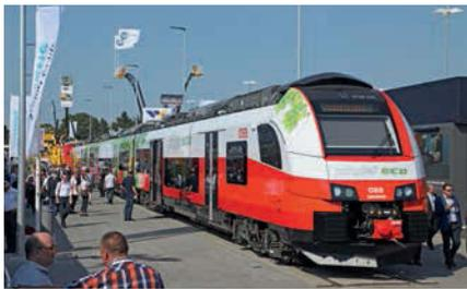
Der CityJet eco von Siemens für die ÖBB mit einem Batteriezusatzantrieb; auf dem Mittelwagen befinden sich u.a. die drei Batteriecontainer.
