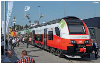
Der CityJet eco von Siemens für die ÖBB mit einem Batteriezusatzantrieb; auf dem Mittelwagen befinden sich u.a. die drei Batteriecontainer.
